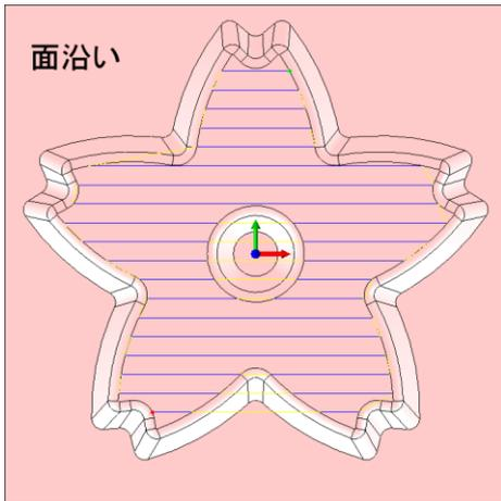
面沿いは、作成した面の方向に沿ったパスを生成します。ロフトやスイープで作成した面も作成した面が平面になれば、平面の軸方向のパスが常に生成されます。
